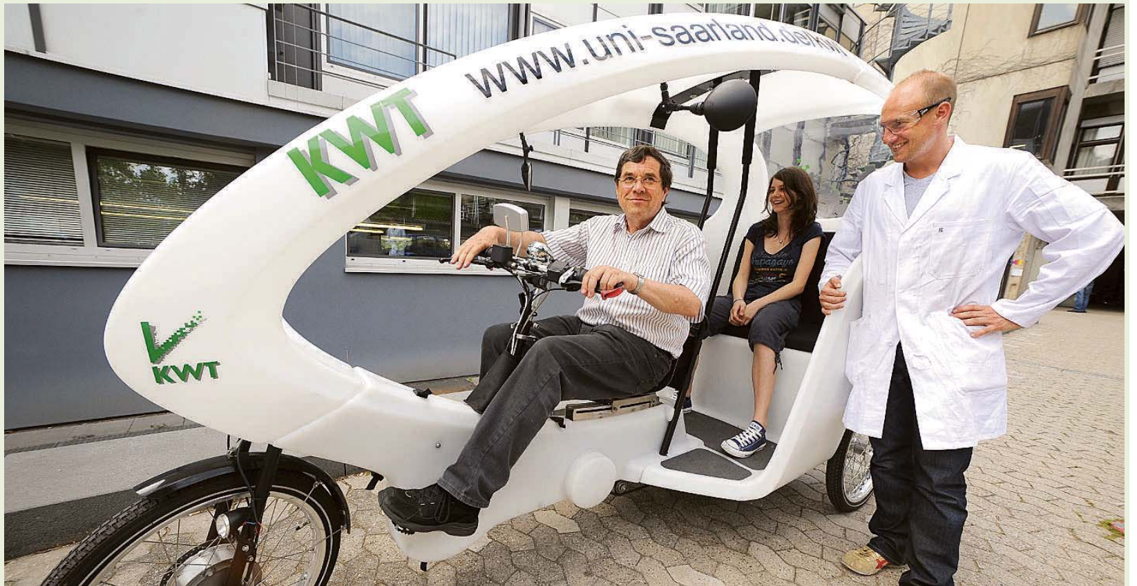
Professor Rolf Hempelmann (links) steuert das Fahrrad-Taxi der Saar-Uni. Das Gefährt besitzt eine Batterie und eine Brennstoffzelle, die den Fahrer beim Treten in die Pedale unterstützen.
