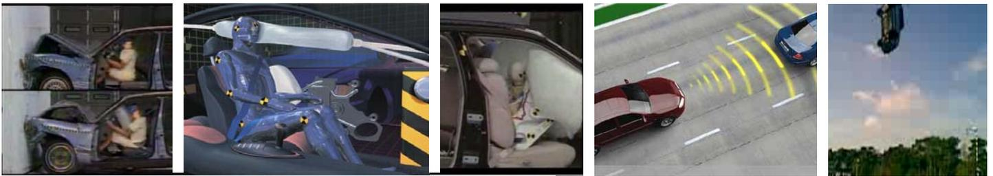
Damit der Airbag nicht mehr schadet als er nützt, wird weiter geforscht und entwickelt. Heute werden z.B. Gewichtssensoren in die Autositze eingebaut, damit das Auto zwischen einem schweren Erwachsenen und einem leichten Kind unterscheiden kann. Dann wird der Airbag nur so fest aufgeblasen, wie es für die Situation erforderlich ist – wenn gar niemand auf dem Sitz ist, explodiert der Airbag auch nicht.
